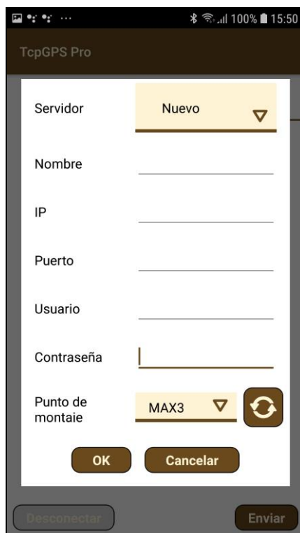
Figura 10. Configuración de un servidor NTRIP
