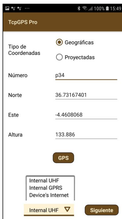
Figura 1. Pantalla para la introducción de coordenadas de la base
