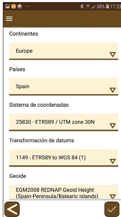
Figura 19. Configuración de un nuevo sistema de coordenadas
