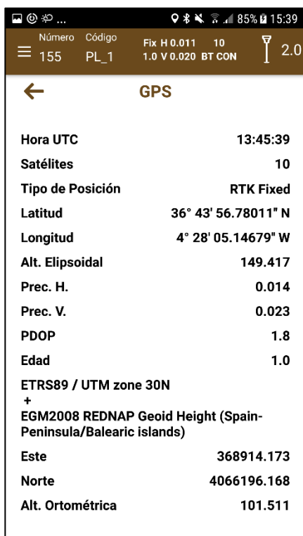
Figura 13. Estado del GPS
