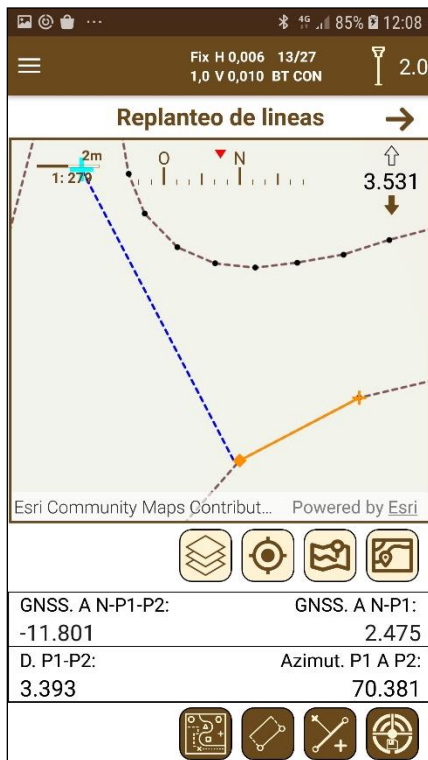
Figura 80. Replanteo de líneas
