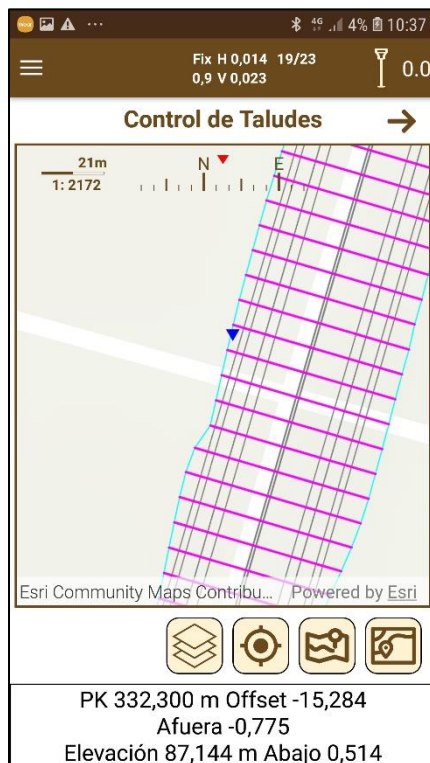
Figura 89. Control de taludes (vista en planta)
